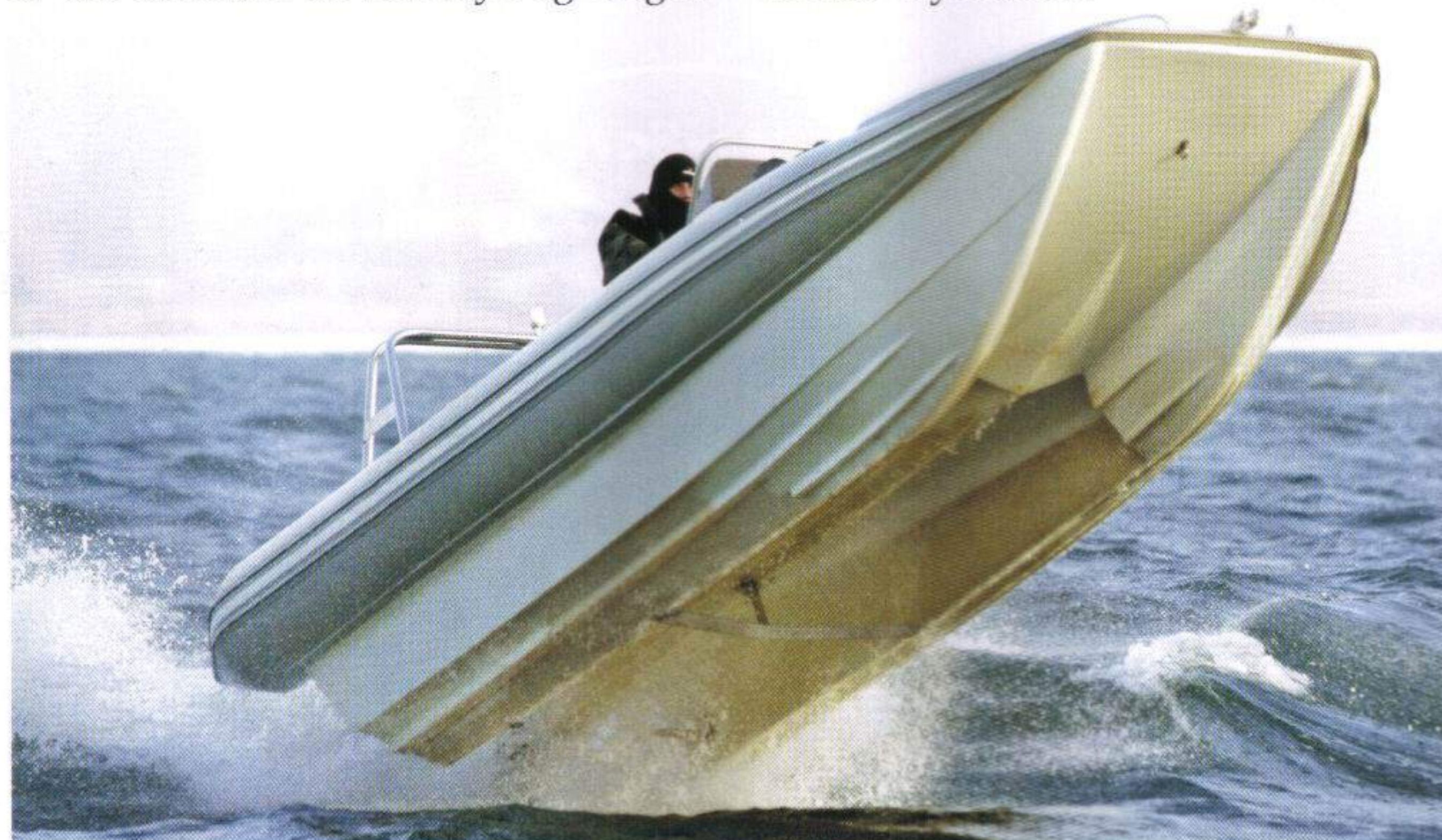
I høj sø er det begrænset hvor meget hydrofoil-skien og de to finner får båden til at "flyve". Læg mærke til den tværgående ski mellem de to kat-pontoner.
